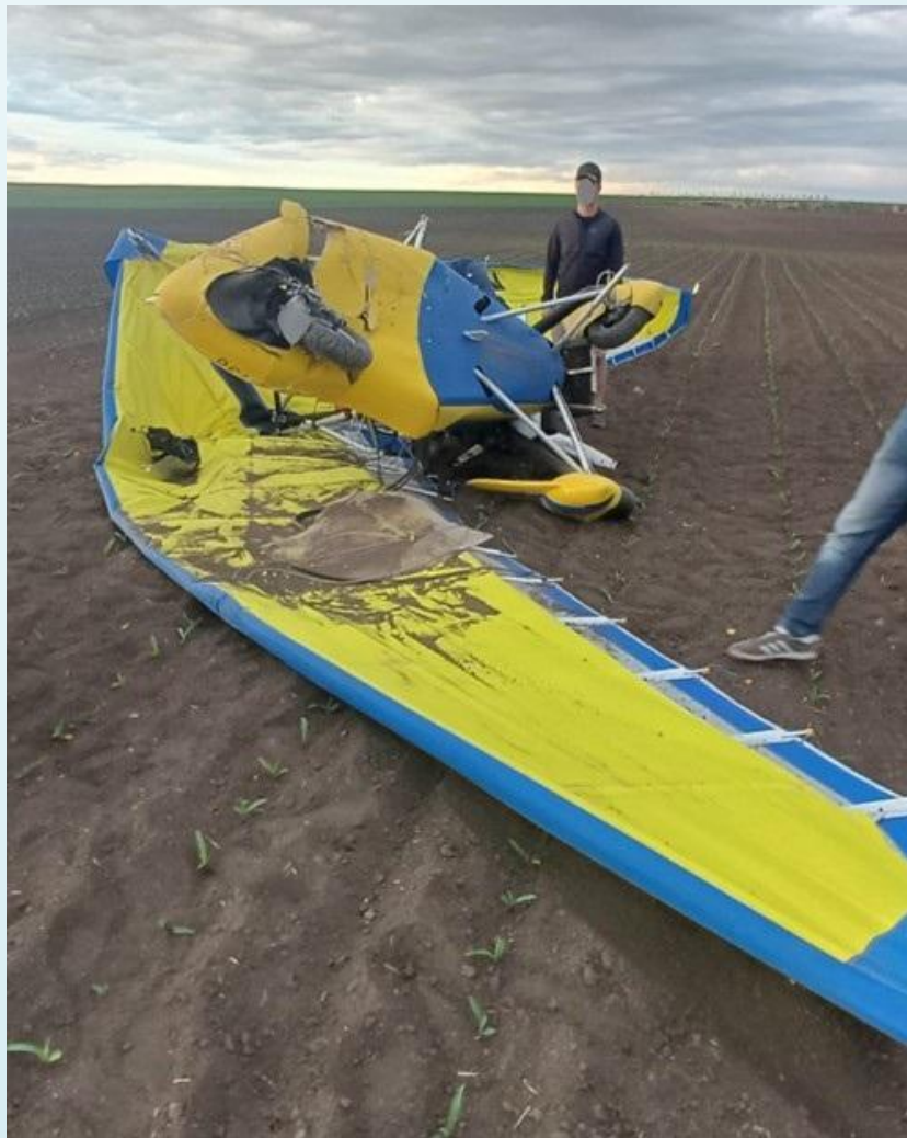
Poškozený MZK Apollo Delta Jet
