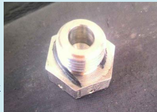
Poškozený těsnící kroužek
